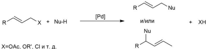
Рис. Схема реакции Цудзи – Троста
