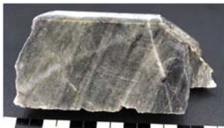
Рис. 1. Образец полосчатого сульфидизированного березита
